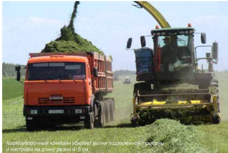
Кормоуборочный комбайн убирает валки подвяленной люцерны и настроен на длину резки 4-5 см
