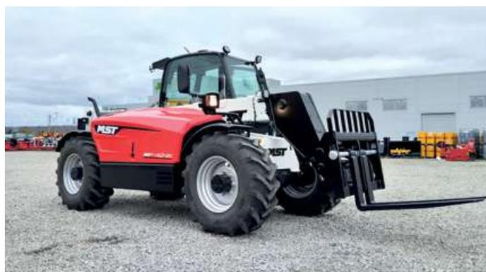
рамой, номинальной грузоподъемностью 3 т и эксплуатационной массой до 10 250 кг. Машина поставляется дилером в трех основных комплектациях и в зависимости от потребностей агропроизводства может быть индивидуально сконфигурована. Данная модель уже успела себя хорошо зарекомендовать на
