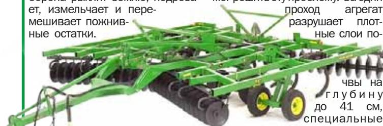
Задние дисковые батареи выравнивают верхний слой почвы. Слегка вогнутые сферические диски и фиксированный угол атаки передней дисковой батареи обеспечивают высокую рабочую скорость машины. После прохода комбинированного агрегата грунт становится ровным и полностью покрытым растительными остатками. Благодаря этому почва защищена от эрозии и испарения влаги.
