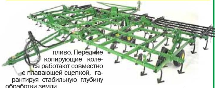
пливо. Передние копирующие колеса работают совместно с плавающей сцепкой, гарантируя стабильную глубину обработки земли.
