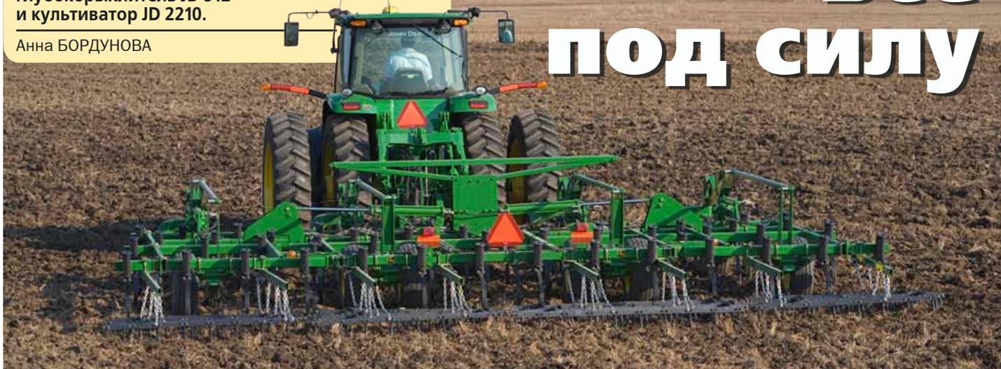
**Дисковый глубокорыхлитель John Deere 512** подходит для основной обработки почвы. Благодаря специальной конструкции с параболическими рыхлительными стойками и пружинным предохранителем борона рыхлит землю, подрезает, измельчает и перемешивает пожнив-ные остатки.
