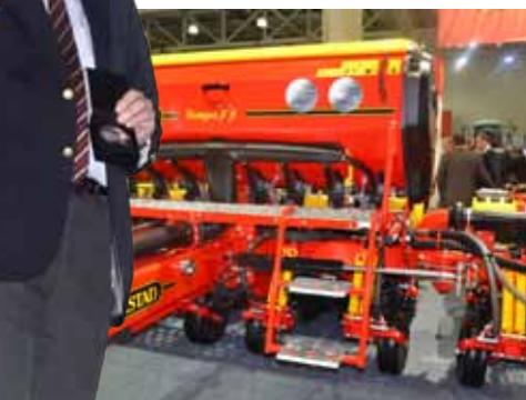
высоким давлением семена «выстреливают» из семяпровода со скоростью 40 м/с. Это минимизирует воздействие вибрации и сохраняет исключительную точность высева, несмотря на высокую скорость и на неровности почвы. Быстрое прикатывание исключает эффект «подпрыгивания». На протяжении 15 лет инженеры Vaderstad разрабатывали эту сеялку, провели много исследований, чтобы узнать, как семя ложится в посевное ложе и как сделать так, чтобы скорость не влияла на точность
